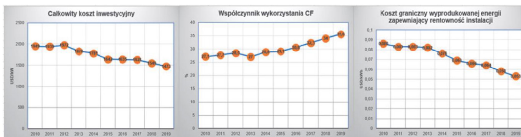
Rys. 21. Charakterystyki przedstawiające zmienność cen instalacji, współczynnika wykorzystania i kosztu granicznego wyprodukowanej energii zapewniającego rentowność elektrowni wiatrowych lądowych [15]
